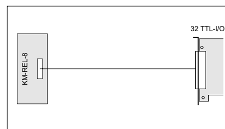
8 isol. Ausgänge 5A
