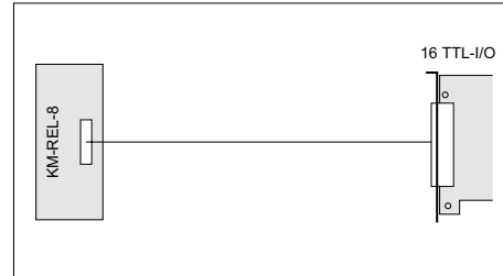
8 isol. Ausgänge 5A
