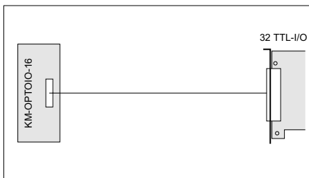
16 isol. Eingänge, 16 isol. Ausgänge 150mA
