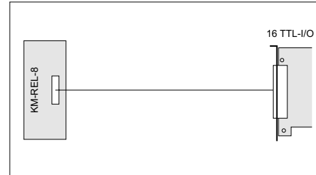
8 isol. Ausgänge 5A
