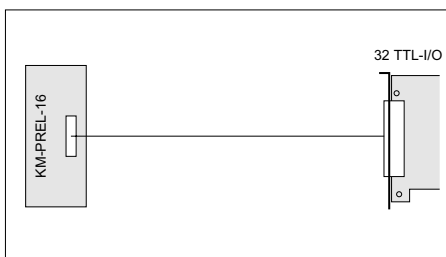
16 isol. Ausgänge 2A
