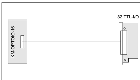
16 isol. Eingänge, 16 isol. Ausgänge 150mA
