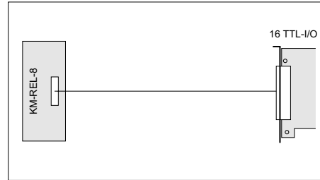
8 isol. Ausgänge 5A
