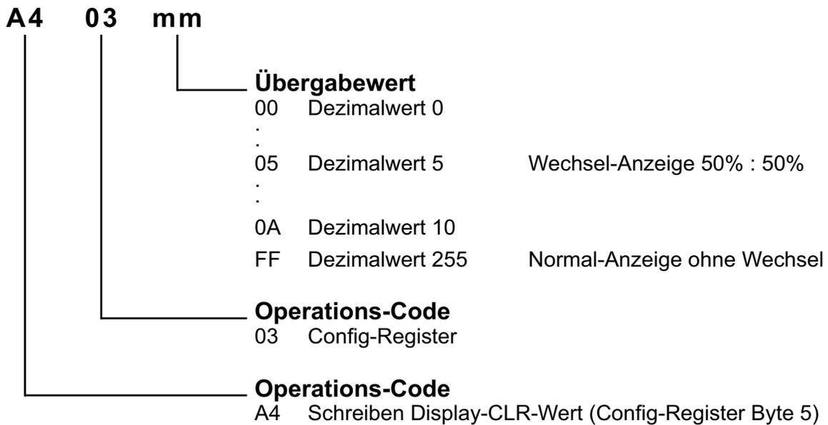
Der Display-Clear-Wert (Display-CLR-Wert) legt den Clear-Zeitraum 1/10...9/10 des Blinkintervalls (2 Sekunden) fest. Dieser Blink- bzw. Wechsel-Anzeige-Modus dient als Displayschoner um einen „Screen-Burn“ zu vermeiden. Die vom User eingestellte „Normal-Anzeige“ (Kommunikations- bzw. Refresh-Anzeige) wird gelöscht und wie im Display-CLR-Modus-Byte festgelegt, nur Leerzeichen oder die Daten der Register User-Bereich A bzw. User-Bereich B angezeigt.
