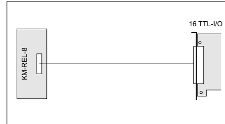
8 isol. Ausgänge 5A
